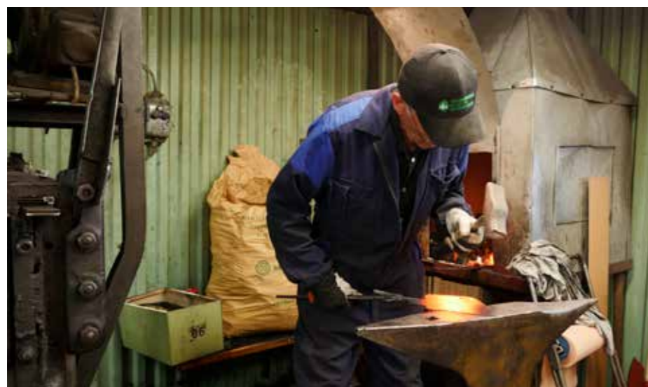
Med exakta hammarslag formar Gunnar ämnet till ett knivblad.
